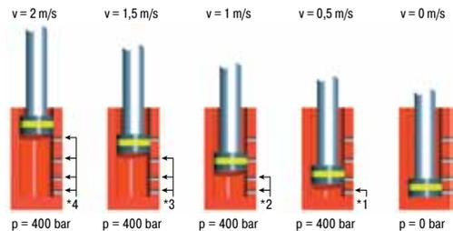
\* Die Anzahl der wirksamen Drosselstellen vor dem Kolben wird weniger, die Geschwindigkeit nimmt über den Bremsweg kontinuierlich ab. Der Innendruck bleibt nahezu konstant und damit die Kraft-Weg-Kurve nahezu linear.
