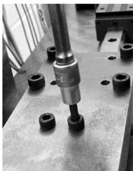
7. Druckluft wegnehmen, das System richtet sich aus, Schrauben jetzt mit definierten Momenten (Tabelle 1) festziehen, Vorgang evtl. in mehreren Schritten durchführen.
