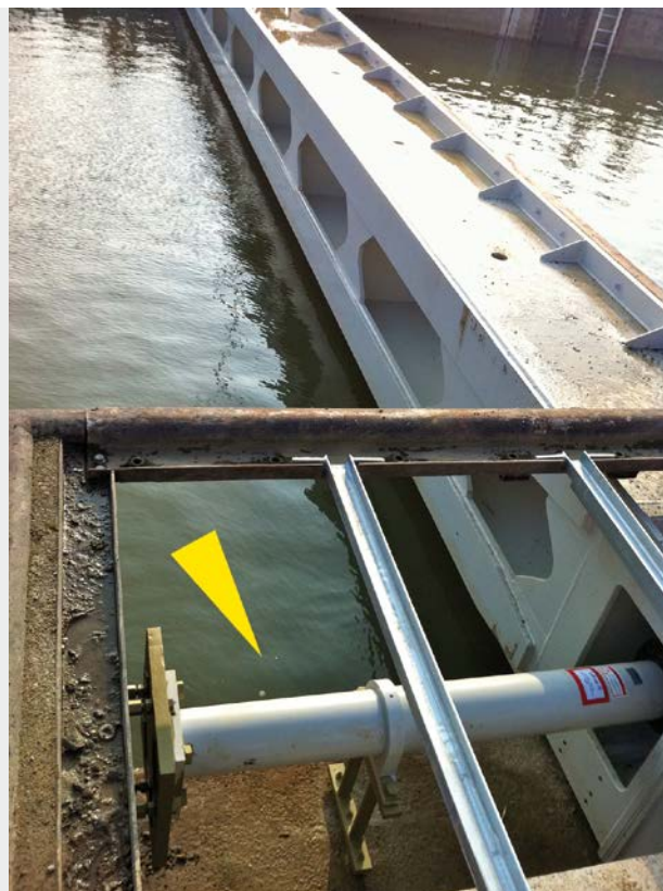
I deceleratori di sicurezza, serie pesante, espressamente studiati per questa applicazione, sono in grado di frenare masse fino a quattro milioni di kg. Mourik Limburg BV, 6101 AJ Echt, Paesi Bassi
